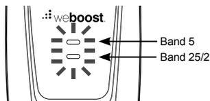
**Vert** indique que l'amplificateur de signal est allumé et fonctionne avec un gain maximum.
