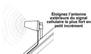
2. Si le voyant reste orange, ou s'il est vert/orange et clignote, indiquant que le gain réduit n'est pas suffisant pour la zone à couvrir, contactez le Service de soutien technique de weBoost au 866-294-1660.
