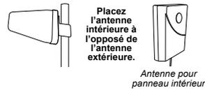
4. Utilisez le matériel de montage compris dans l'emballage pour fixer l'antenne intérieure à l'emplacement voulu.
